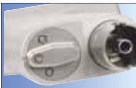
Drehrichtungs-Wählventil für Vor-, Rückwärtslauf und Sicherung.
